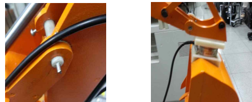
그림 2. 축 가공, 힘 센서 장착모습
